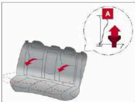
2. Para retornar o encosto do banco traseiro para sua posição original, levante o encosto e empurre-o até a posição vertical. Pressione firmemente as áreas **A** e **B** para travar o encosto na posição adequada.
