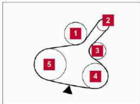
1. Inspeccione visualmente a correia quanto a sinais de desgaste incomum, cortes ou rachaduras. Caso a correia esteja em condições insatisfatórias, providencie para que seja substituída ou ajustada em uma concessionária Nissan.
