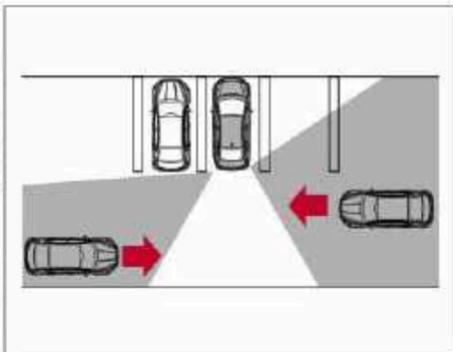
O sistema RCTA\* utiliza sensores de radar **1** instalados próximos ao para-choque traseiro, em ambos os lados, para detectar a aproximação de um veículo.
