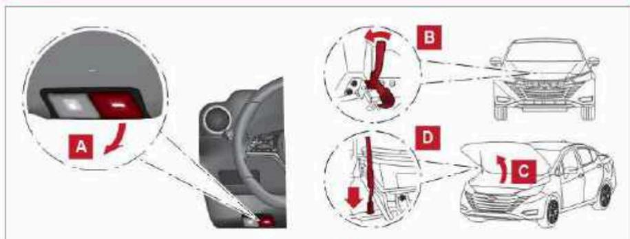
1. Puxe a alavanca de liberação da trava do capô **A** localizada abaixo do painel de instrumentos, lado do motorista. O capô irá saltar levemente.
